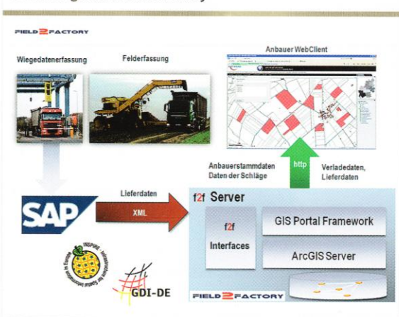
Abbildung: Aufbau field2factory
