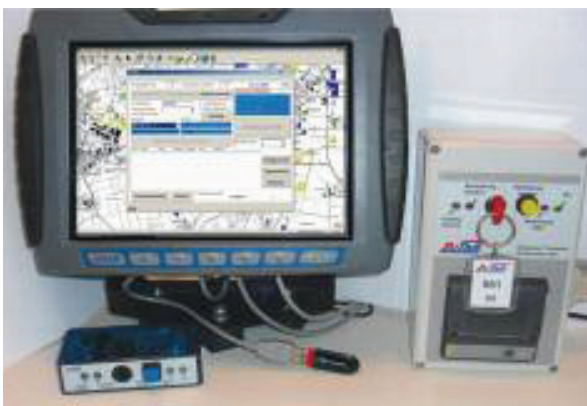
Bordrechner mit Datakeydruckerbox und blauem Funkmodul.
