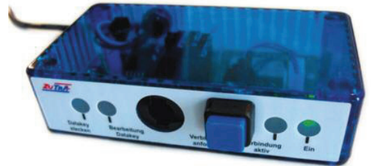
Mobile Datakeyfunkbox für Fahrzeuge
